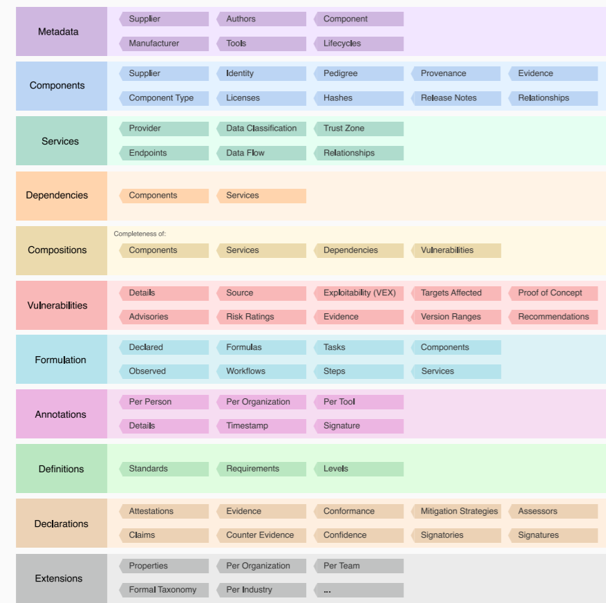
Figure 9: Modèle de nomenclature dans la spécification CycloneDX [10]
